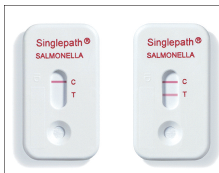
Рис. 1. Иммунохроматографический тест Singlepath® Salmonella для экспрессного определения сальмонелл. Слева – отрицательный ответ; справа – положительный ответ
